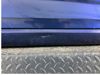
Marşbiyel, sağ, Marşbiyel, sağ > Hasarlı
