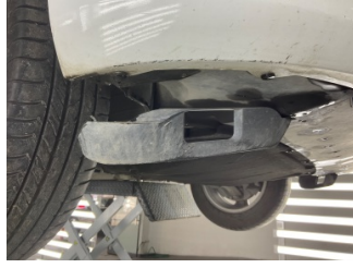
Tampon, ön, Spoiler > Hasarlı
