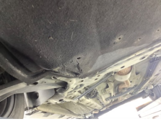
Motor, Alt muhafaza > Hasarlı
