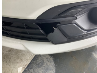
Tampon, ön, Ön tampon ızgarası > Hasarlı
