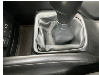
Şanzıman, Vites körüğü > Hasarlı
