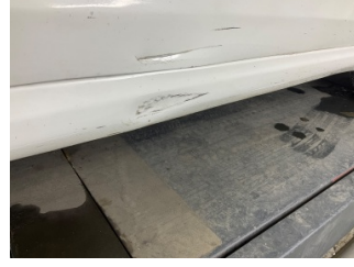
Marşbiyel, sağ, Marşbiyel, sağ > Hasarlı
