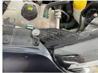
Farlar, Far, sol > Hasarlı
