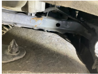
Kaporta, Sol Ön Şase > Hasarlı
