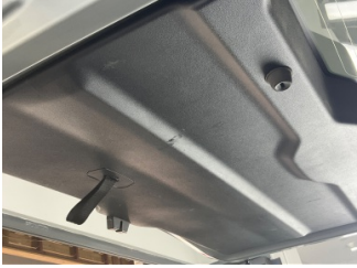
Döşemeler/Kapaklar, Bagaj kapağı, iç döşemesi > Çizik
