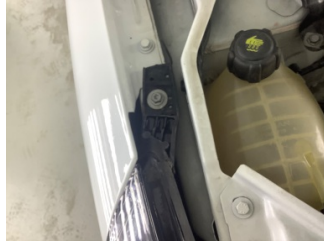
Farlar, Far bağlantı ayağı, sağ > Hasarlı
