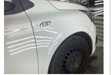
Elektrik sistemi, Aydınlatma > Sabitlemesi Hatalı
