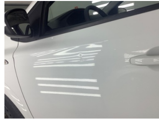
Kapı, sol ön, Kapı, sol ön > Ezik
