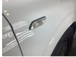
Elektrik sistemi, Aydınlatma > Sabitlemesi Hatalı
