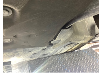
Kaporta, Muhafaza, orta > Hasarlı
