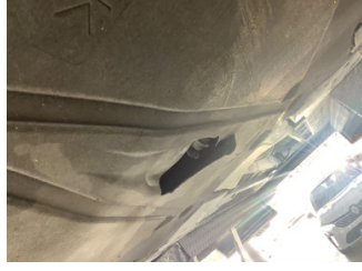
Motor, Alt muhafaza > Hasarlı
