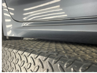
Marşbiyel, sağ, Marşbiyel plastığı, sağ > Çizik
