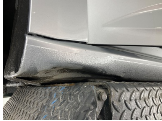
Marşbiyel, sol, Marşbiyel, sol > Hasarlı
