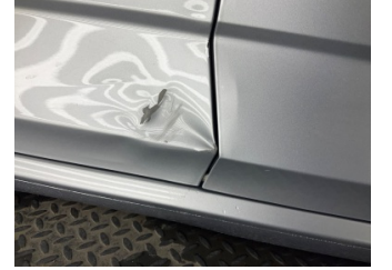
Kapı, sağ arka, Kapı, sağ arka > Hasarlı
