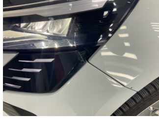
Farlar, Far, sol > Hasarlı
