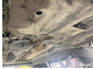
Motor, Alt muhafaza > Hasarlı
