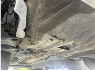
Motor, Alt muhafaza > Hasarlı
