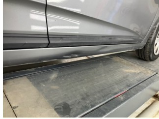
Marşbiyel, sağ, Marşbiyel, sağ > Hasarlı
