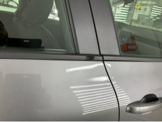
Kapı, sağ arka, Cam sıyrıcı fitili, dış > Hasarlı
