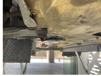
Motor, Alt muhafaza > Hasarlı
