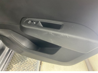
Döşemeler/Kapaklar, Kapı döşemesi, sağ arka > Hasarlı
