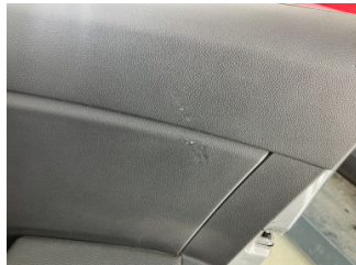
Döşemeler/Kapaklar, Kapı döşemesi, sağ ön > Hasarlı
