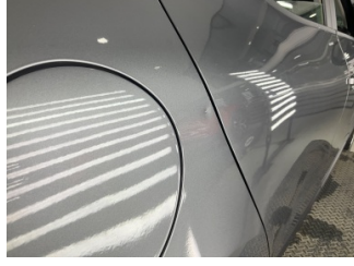
Çamurluk, sağ arka, Çamurluk, sağ arka > Ezik
