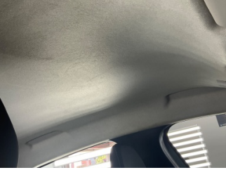
Döşemeler/Kapaklar, Tavan döşemesi > Kirlenmiş
