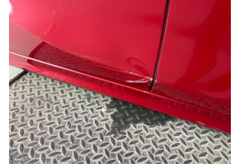
Kapı, sağ arka, Kapı, sağ arka > Hasarlı
