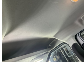
Döşemeler/Kapaklar, Tavan döşemesi > Deforme Olmuş
