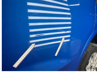
Kapı, sol arka, Kapı, sol arka > Çizik
