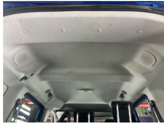
Döşemeler/Kapaklar, Tavan döşemesi > Kirlenmiş
