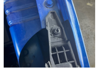
Farlar, Far, sol > Hasarlı
