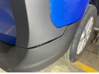
Tampon, arka, Arka tampon > Sabitlemesi Hatalı
