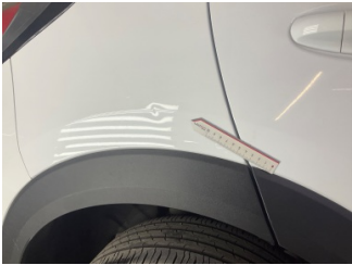
Çamurluk, sağ arka, Çamurluk, sağ arka > Ezik
