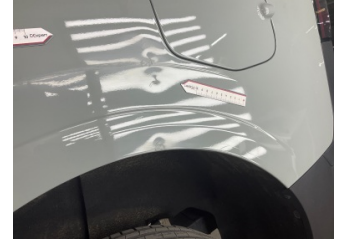
Çamurluk, sol arka, Çamurluk, sol arka > Hasarlı
