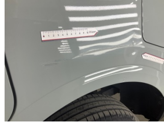
Çamurluk, sol arka, Çamurluk, sol arka > Hasarlı
