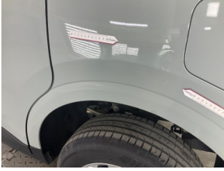
Çamurluk, sol arka, Çamurluk, sol arka > Hasarlı
