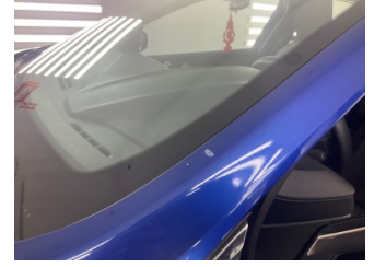
Tavan, Ön cam direği, sol > Boyası Atmış
