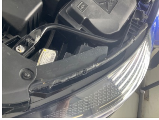
Farlar, Far, sol > Standart Dışı Onarım
