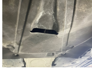
Motor, Alt muhafaza > Hasarlı
