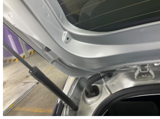
Döşemeler/Kapaklar, Bagaj kapağı, iç döşemesi > Eksik
