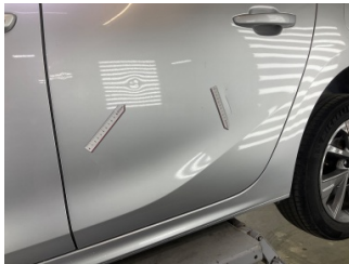
Kapı, sol arka, Kapı, sol arka > Hasarlı
