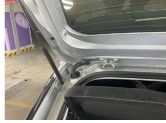
Döşemeler/Kapaklar, Bagaj kapağı, iç döşemesi > Eksik
