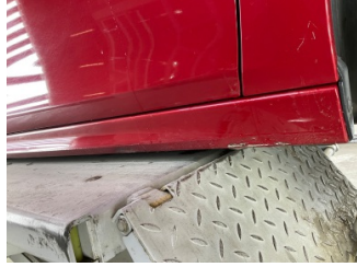
Marşbiyel, sağ, Marşbiyel, sağ > Hasarlı
