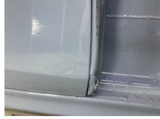
Kapı, sağ arka, Kapı fitili > Deforme Olmuş
