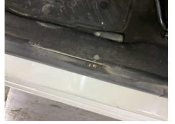
Kapı, sol ön, Kapı fitili > Hasarlı
