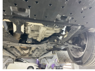
Motor, Alt muhafaza > Hasarlı
