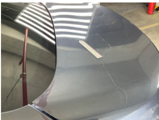
Bagaj kapağı/kapısı, Bagaj kapısı > Ezik
