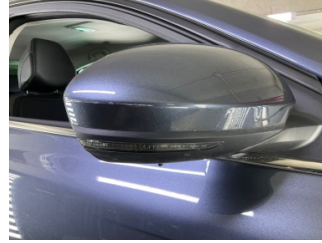
Dikiz aynası, sağ, Dış dikiz aynası > Çizik
