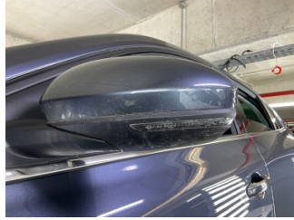
Dikiz aynası, sol, Dış dikiz aynası > Çizik
