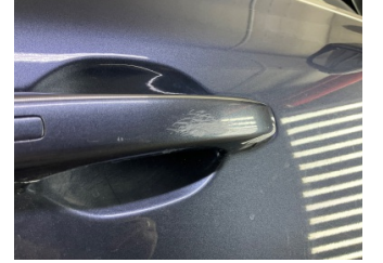
Kapı, sağ ön, Kapı kolu, dış > Çizik
