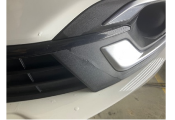
Sis lambaları, Sis Izgarası Sol > Hasarlı
