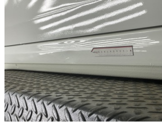
Marşbiyel, sol, Marşbiyel, sol > Hasarlı
