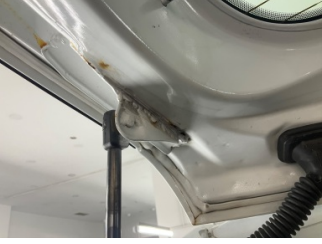
Bagaj kapağı/kapısı, Bagaj kapısı > Standart Dışı Onarım
